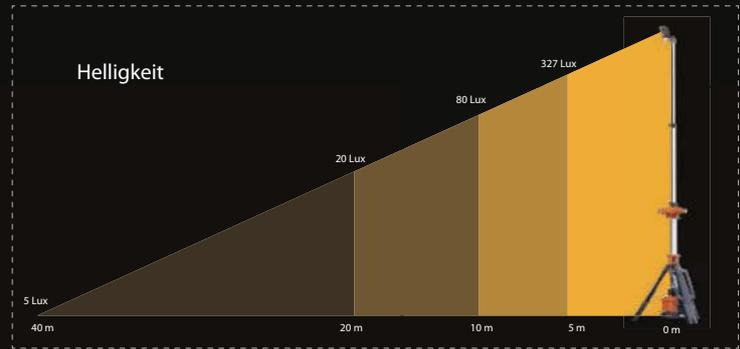
\* Die "Helligkeit" stellt den Wert der Beleuchtungsstärke im Mittelpunkt der Beleuchtungsrichtung dar.
